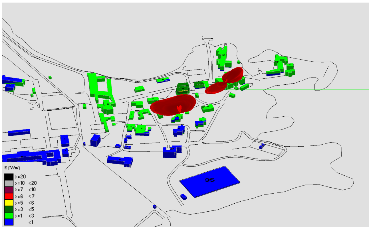
Fig. 32 Impatto Elettromagnetico – zona Pianosa – 0° N
